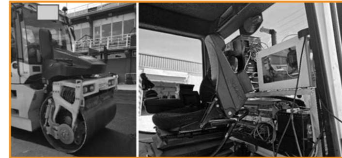
Figura 31.- Sistema de adquisición montado en máquina móvil.
