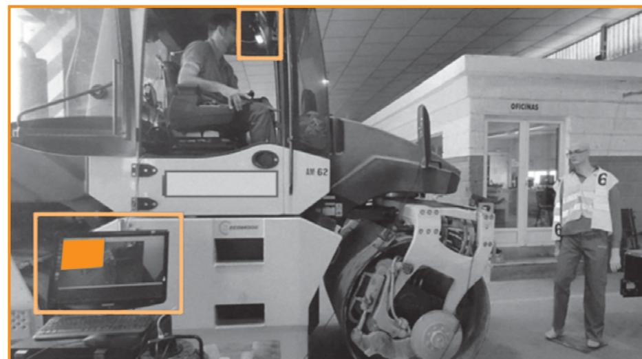
Figura 35.- Alarmas riesgo medio y alto, con paralización de la máquina.
